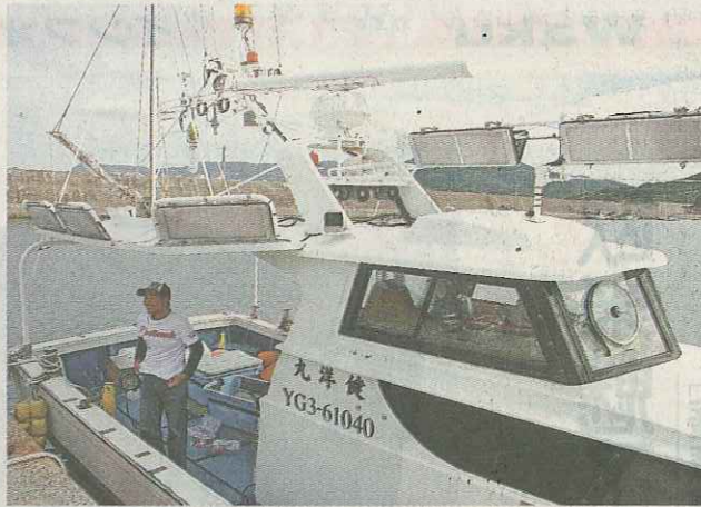
LED集魚灯を搭載するなど省エネに配慮した山口型モデル漁船
